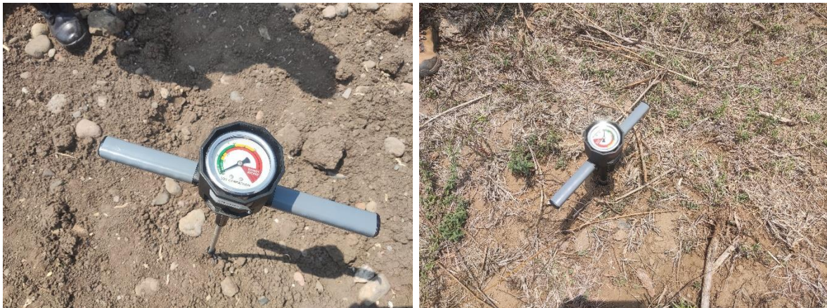
Figura 24 y 25. Medidor sencillo de compactación del suelo en dos tipos de suelo (véase la diferencia en la penetración del aparato en el suelo).
