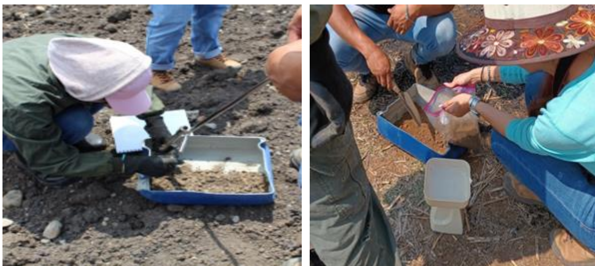
Figura 17 y 18. Toma de muestras, mezclado para hacer la mezcla compuesta, pesado y envasado.
