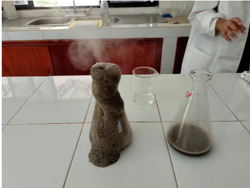
Figura 22. Prueba de laboratorio para medir respiración a nivel cualitativo del suelo. Aplicación de HCl 0.1 M Matraz de la izquierda, suelo con alto nivel de materia orgánica (m.o.) y microorganismo. Matraz derecho, bajo nivel de m.o. y bajo nivel microorganismos.
